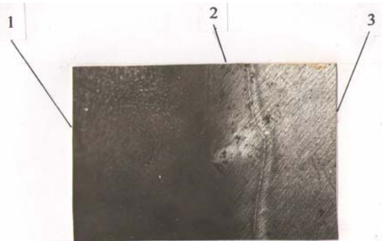
Рис. 2. Мікрофотографія перехідних областей після травлення в АВ-травнику тришарової структури: підкладка (1); перехідна частина підкладки – епітаксійний шар (2); перехідна частина – третій епітаксійний шар (3).
