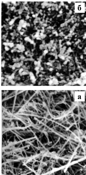
Рис. 3. Фотографії «пророслих» волокнистих частинок (а) та черв'яковидних утворень у вуглецьвмісному склі (20000 \times ) (б).
