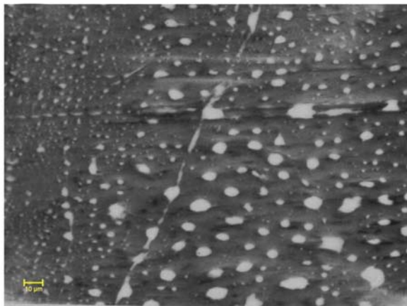
Рис. 2. Зображення структури поверхні кристалів кремнію, одержане методом растрової електронної мікроскопії відразу після завершення магнітної обробки (X1000).
