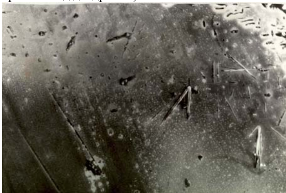
Рис. 8. Електронне зображення двійникових ламелей на поверхні кремнієвої пластини КДБ 10 (100) (x 2300).
