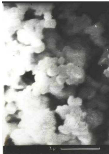
Рис. 2. поверхня порошків хрому (а) і оксиду хрому (б).
