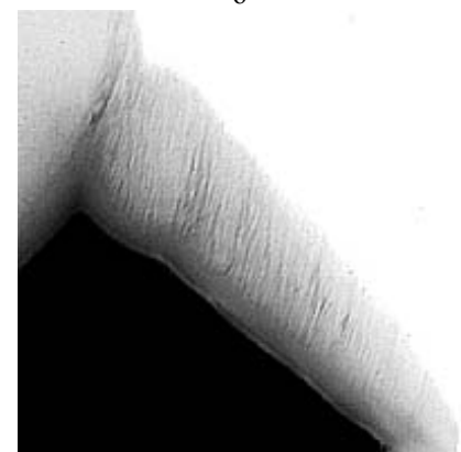
Рис. 2. Мікрофотографії поверхні плівок: а) товщина менше h_c , б) товщина більше h_c , в) поперечний злам плівки товщиною 400 нм.
