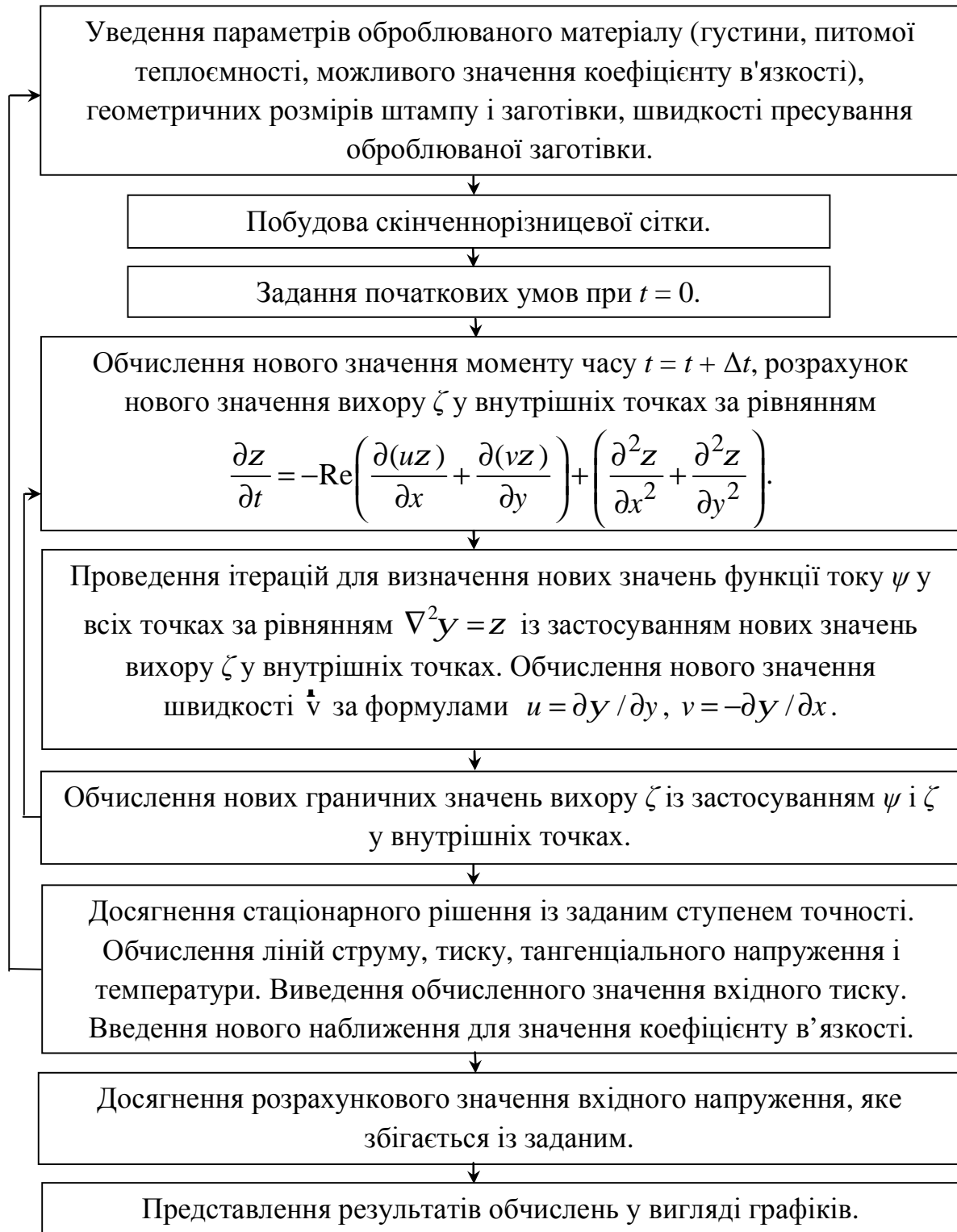
Рис. 2. Блок-схема алгоритму розв'язання рівняння Нав'є-Стокса, записаного у випадку рівноканального кутового пресування для змінних функції току \psi і вихору \zeta
