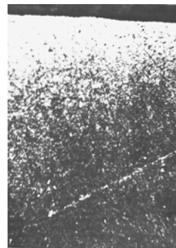
Рис. 1. Мікроструктура зміцненого шару сталі Р6М5 після магнітно-абразивної обробки (x 400).
