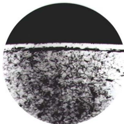
Рис. 1. Карбохромовий шар на сталі ВСт.3 з різко вираженою підшаровою зоною.
