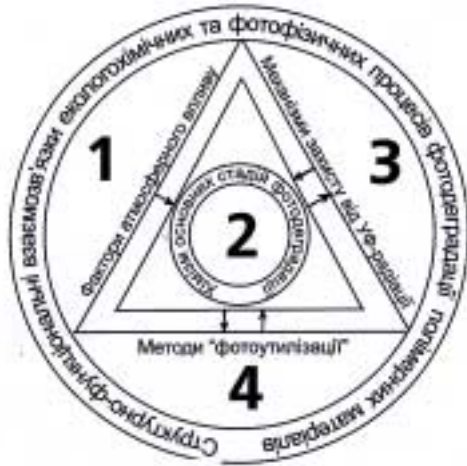
Рис. 2. Загальна модельна схема ультрафіолетової деградації та структурно-функціональні взаємозв'язки між етапами розвитку фотосенсибілізованого окиснення полімерних матеріалів.
