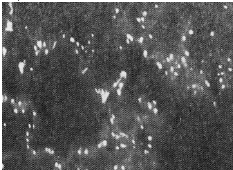
Рис. 2. Мікрофотографія дрібнодисперсного \gamma - \text{Fe}_2\text{O}_3 №3. Середній розмір частинок 11,5...18,0 нм.
